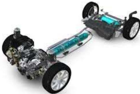
**Hybrid-Air-Technik** von Bosch / PSA setzt auf mechanischen Ölspeicher statt Batterien. Soll bis zu 45% Benzineinsparung und 30% Co2 Reduzierung bringen
