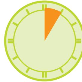
**Fünf Minuten** nach Ausschalten des Hochvolt-Systems (automatisch nach einem Aufprall oder durch Fahrereingabe) ist die Restspannung im Hochvoltnetz abgebaut. Die Spannung in der Traktionsbatterie bleibt jedoch erhalten.
