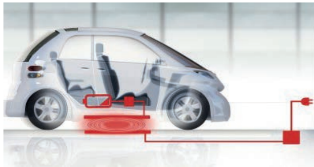
Abbildung 2.11: Induktives Ladesystem der Firma SEW 1
