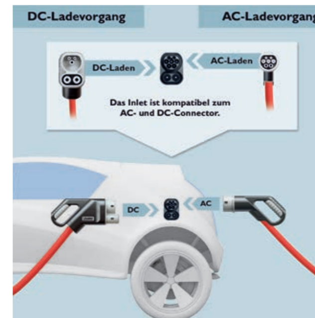
Abbildung 2.9: Kombiniertes AC-/DC-Ladesystem Typ 2 (Combined Charging System, CCS) zur Unterstützung von Normalladung mit Wechselstrom und Schnellladung mit Gleichstrom 2
