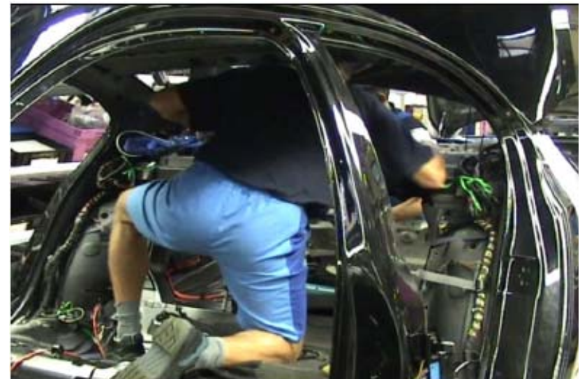
Verlegen des Kabelbaums auf der Hutablage
