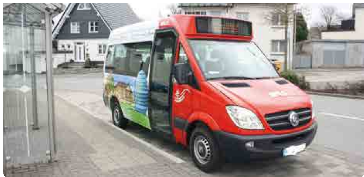
Elektrisch betriebener Minibus (Umbau; Basisfahrzeug Mercedes Sprinter)
