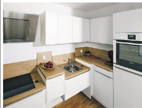
Kochfeld und Spültisch in der ergonomisch gestalteten Küche sind als höhenverstellbare Hubmodule eingebaut. Fotos: GSW Sigmaringen
