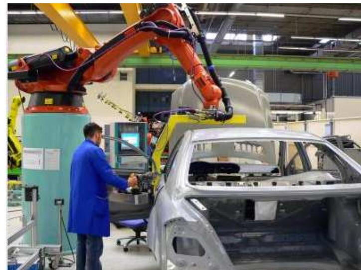
Beispiel: halbautomatisierte Cockpitmontage
