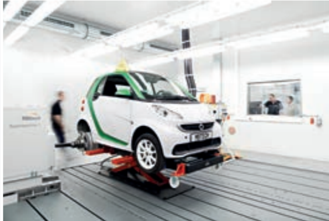
Antriebs-System-Prüfstand in Mönshheim
