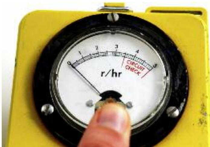
Geigerzähler: Zulieferteile aus Japan auf Radioaktivität überprüfen
